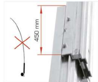
Mayor tramo de seguridad. Evita efecto caña de pescar.
