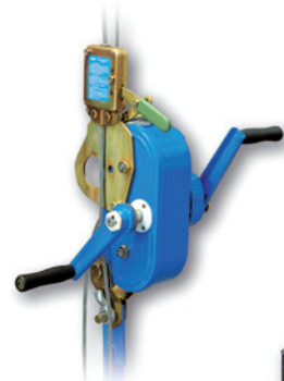
Mod. T500 3 frenos de retención impiden el deslizamiento del cable. La manivela fija no puede girar en sentido contrario al de elevación si no se actúa a propósito para descender.
