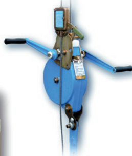
Mod. C0500 Trinquete de retención (actúa continuamente sobre el mecanismo interior impidiendo el descenso). Freno automático de expansión (descenso sin brusquedad).
